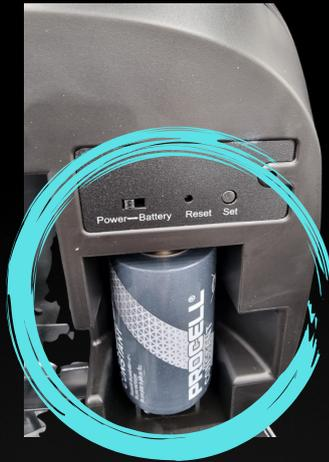
6 Gerät am kleinen Schieberegler auf 'Batterie' stellen
